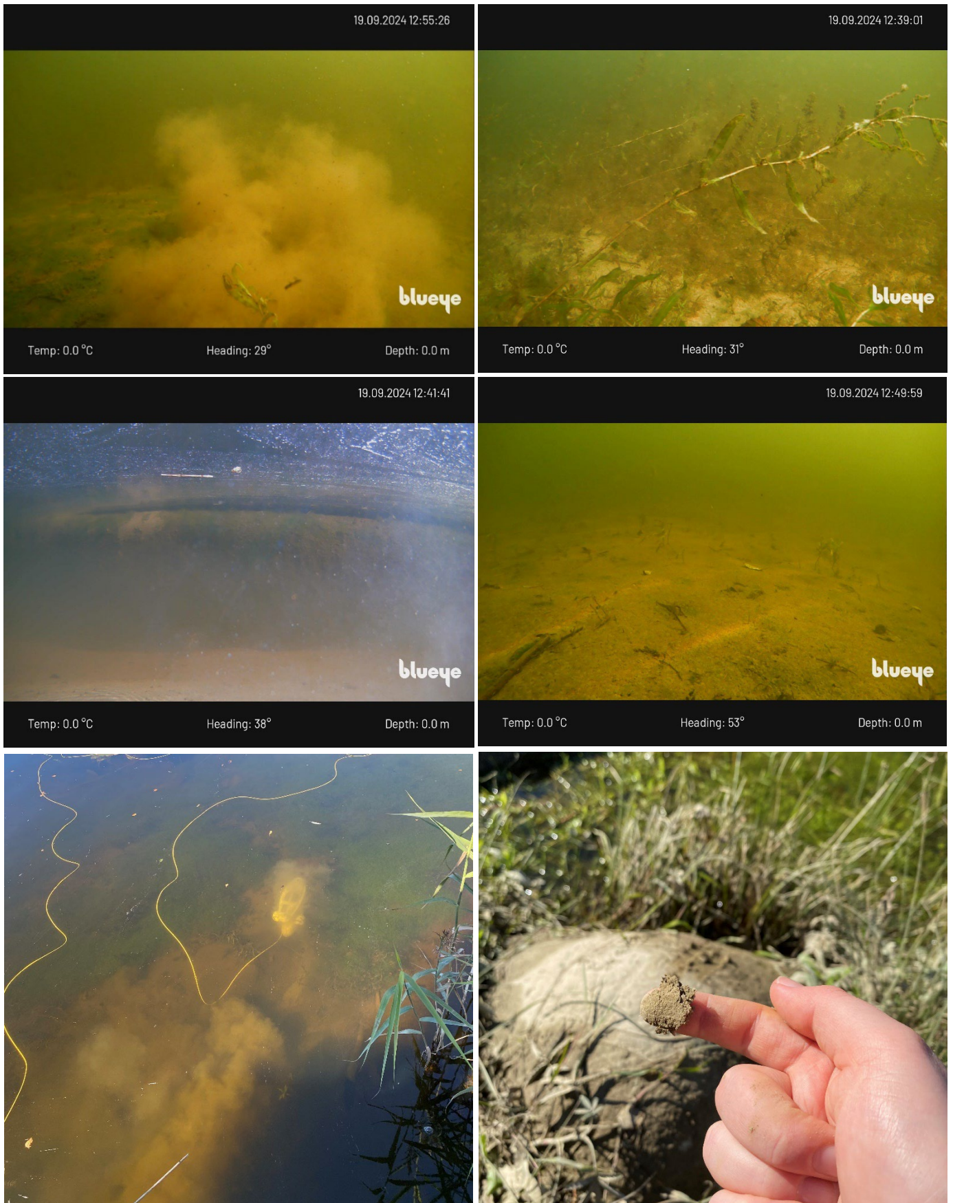
Figur 1.3: Sedimentering langs og rundt elvebunnen i Røyrvikhølen. Siltgarden er synlig i midtre bilde til venstre. Bildene er tatt med undervannsdronne og mobilkamera 19. september 2024.
